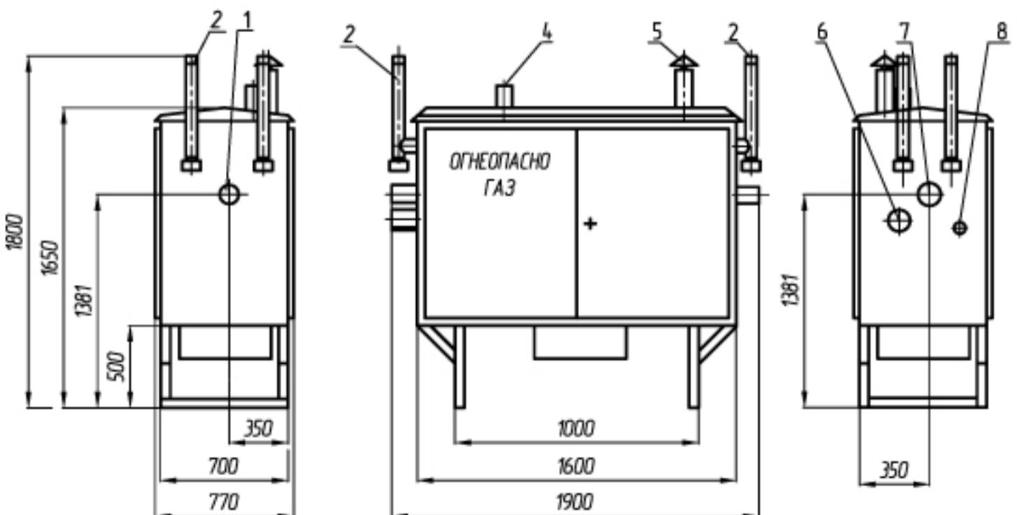
1-Рвх(Ду50); 2-продувочный патрубок (Ду20); 4-выход ПСК-50Н (Ду50); 5-вент. патрубок; 6-вход ПСК-50Н (Ду50); 7-Рвх(Ду50); 8-подвод импульса к регулятору (Ду25).
