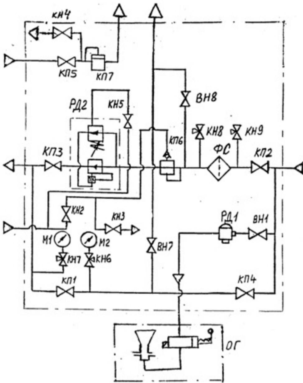
РД1, РД2 – регуляторы давления; ФС – фильтр сетчатый; КП6 – клапан предохранительно-запорный; КН6-КН9 – клапаны трехлинейные; КП1-КП5, КН2-КН5, ВН7-ВН8, ВН1 – запорная арматура; ОГ – обогреватель газовый; М1, М2 – манометры; КП7 – клапан сбросной
